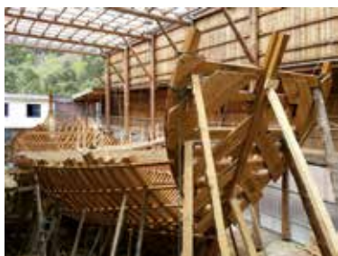
Fig. 15.- Construcción de la nao San Juan en los astilleros de Albaola en Pasaia
